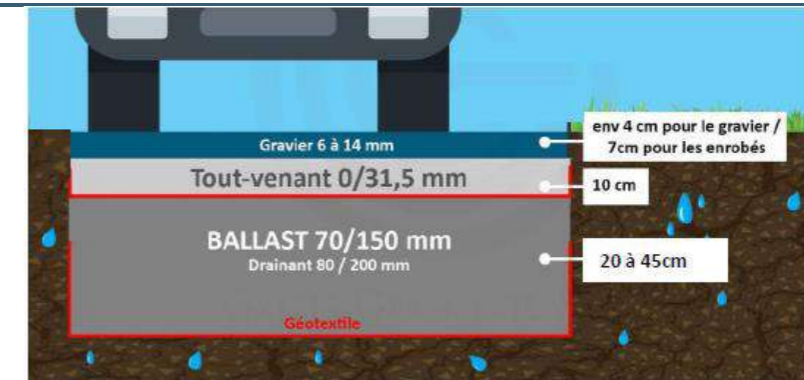
Composition privilégiée des pistes internes et des plateformes de poste (source : ENOE)
